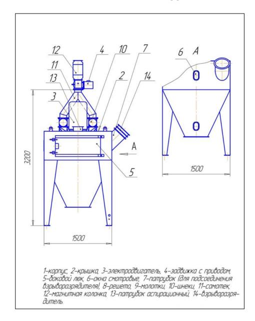
Для поддерживания оптимального режима работы двигателя на крышке дробилки смонтирована задвижка, регулирующая количество подаваемого на дробилку продукта. При отклонении тока от оптимального значения, задвижка открывается или закрывается. Управление задвижкой производится с пульта.
