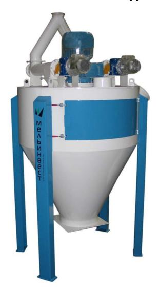
Дробилка Р1-БДК-10М предназначена для измельчения зерна злаковых и пленчатых культур, шротов при производстве комбикормов для свинооткормочных комплексов, крупного рогатого скота, птицефабрик.
